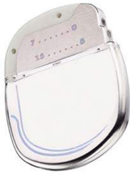
図2 神経刺激装置 (縦57mm/横47mm/厚さ9mm)
